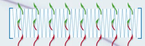
MediaMax Filter mit großer gefalteter Oberfläche.
